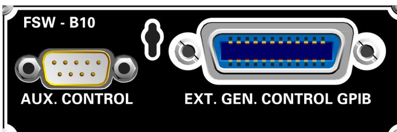
El conector GPIB se puede usar para conectar el generador externo al R&S FSW.
