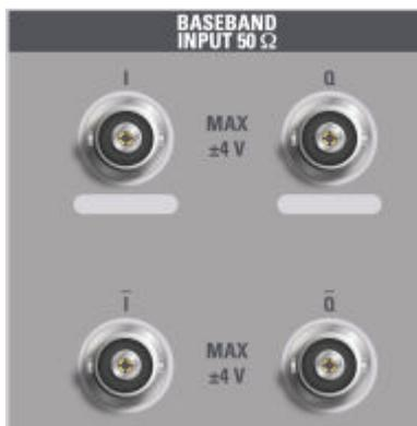
Los conectores BNC superiores BASEBAND INPUT I y BASEBAND INPUT Q se utilizan como entrada de señal en modo común, entrada de señal positiva para señales diferenciales y entrada para **sondas Rohde & Schwarz** activas (R&S RT-ZSxx y sondas diferenciales RT-ZDxx).
