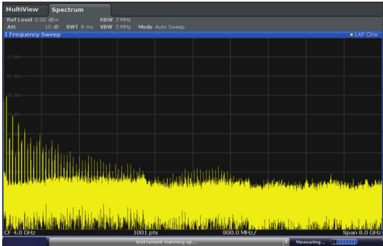
**Fig. 4-1: Señal de calibración como entrada RF**
