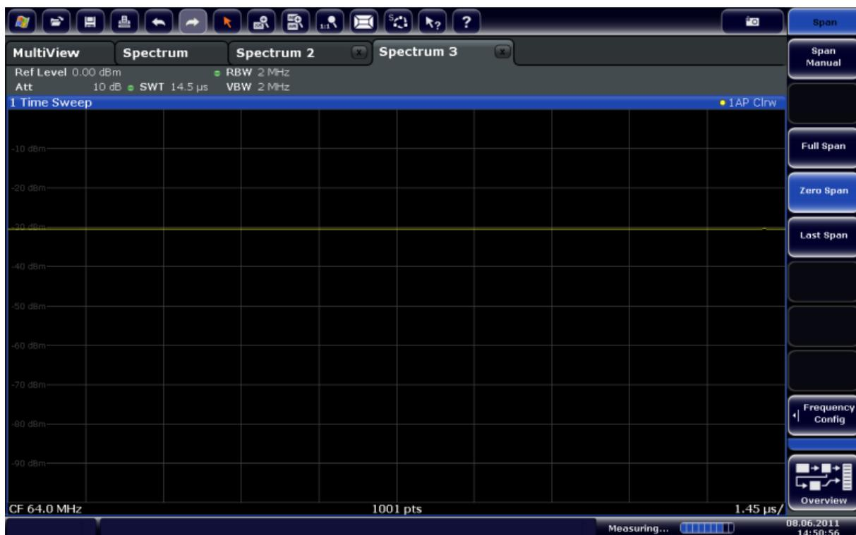
**Fig. 4-7: Representación en el dominio temporal de la señal de calibración**
